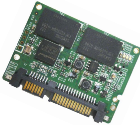
Figure 1: InnoDisk SATA Slim D150Q (BGA)
