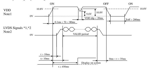
\*1: DA0+/-, DA1+/-, DA2+/-, DA3+/-, DA4+/-, CKA+/-, DB0+/-, DB1+/-, DB2+/-, DB3+/-, DB4+/-, CKB+/-, DC0+/-, DC1+/-, DC2+/-, DC3+/-, DC4+/-, CKC+/-, DD0+/-, DD1+/-, DD2+/-, DD3+/-, DD4+/-, CKD+/-
